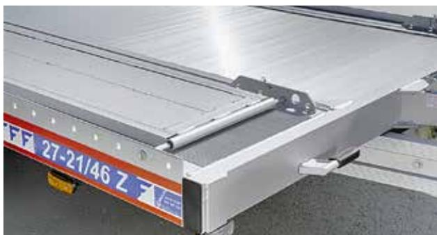
MPV-Plateau: Überfahreinrichtung mit klappbaren Ladeschienen.
