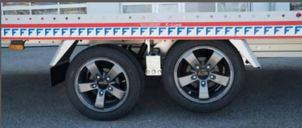
Die Liftachse macht das Rangieren per Hand einfacher und schont bei Leerfahrten die Reifen.
