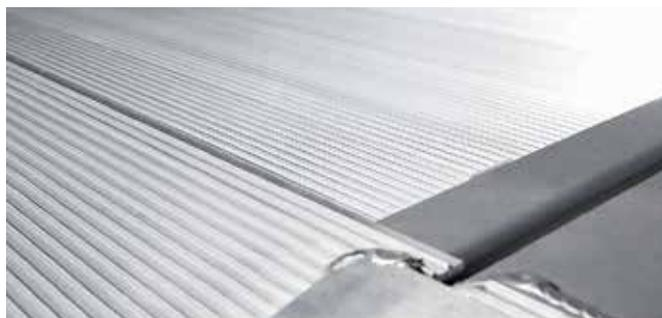
ALU-Bodenplatte aus querliegenden Hohlkammerprofilen
