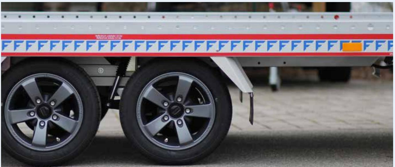
Zu den Alleinstellungsmerkmalen gehört die Pendelachse X-Line, die mit einem Lastausgleich von 100 Prozent ein Höchstmaß an Fahrsicherheit garantiert.
