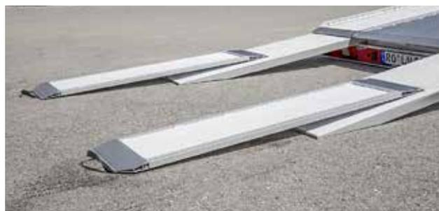
Zusatz-Ladeschienen ermöglichen einen noch flacheren Auffahrwinkel.
