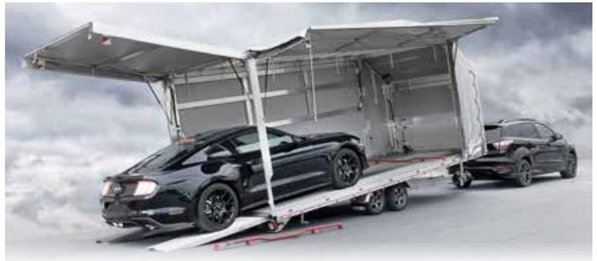
Die Klappversion: Ausstellbare Heckklappe und Seitenklappen mit Gasdruckfedern.
